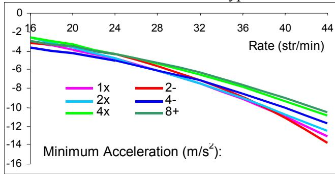
Beachte, daß sämtliche Trends bei niedrigen Schlagfrequenzen sehr dicht beieinander liegen, aber die negative Beschleunigung bei höheren Schlagfrequenzen in den Kleinbooten signifikanter ist.
